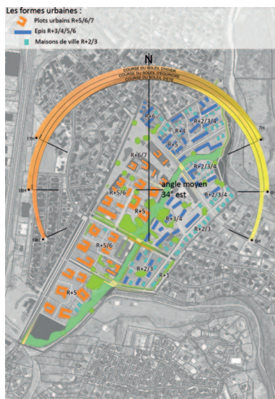
Figure 13 : Plan masse final de la ZAC, épannelage (© LEU Réunion)
