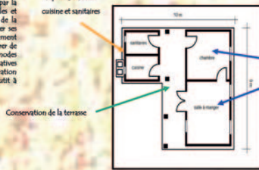
Case expérimentale n°1, construite en 1978 à Mamoudzou Surface totale habitable : 57 m²
